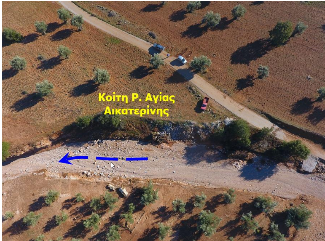
Εικόνα 8: Άποψη του ρ. της Αγίας Αικατερίνης, ανάντη της πόλης της Μάνδρας. Στην φωτογραφία αποτυπώνεται η κοίτη του υδατορέματος με καλή διαμόρφωση (πλάτος ~30μ) καθώς κινείται διαμέσου ενός ελαιώνα (Πηγή φωτογραφίας: Ανδρεαδάκης Ε. 2017).
