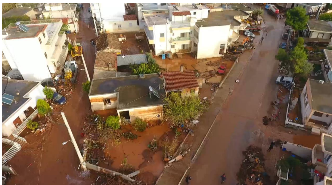
Εικόνα 13: Άποψη της οδού Κοροπούλη στις νότιες παρυφές της πόλης της Μάνδρας, η οποία ταυτίζεται με το ίχνος της κοίτης του υδατορέματος «Αγίας Αικατερίνης». Στο στιγμιότυπο φαίνονται κατασκευές (κατοικίες και επιχειρήσεις) οι οποίες βρίσκονται εκατέρωθεν της οδού και της παλαιάς κοίτης του υδατορέματος αποτελώντας εμπόδιο στην ροή των υδάτων, ενώ στη θέση που απεικονίζεται έχασαν τη ζωή τους δύο άτομα εντός κατοικιών οι οποίες πλημμύρισαν (Πηγή φωτογραφίας: Ανδρεαδάκης Ε. 2017).
