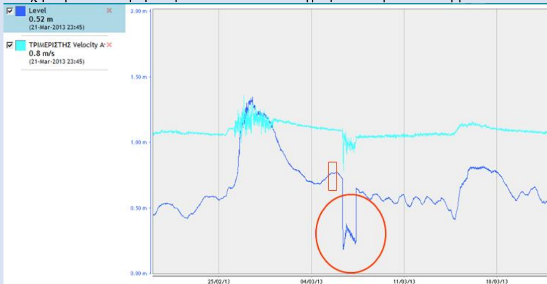
Εικ 7 Δεδομένα παρακολούθησης από σταθμό επιφανειακών υδάτων (παρακολούθηση εξέλιξης πλημμυρικού φαινομένου)
