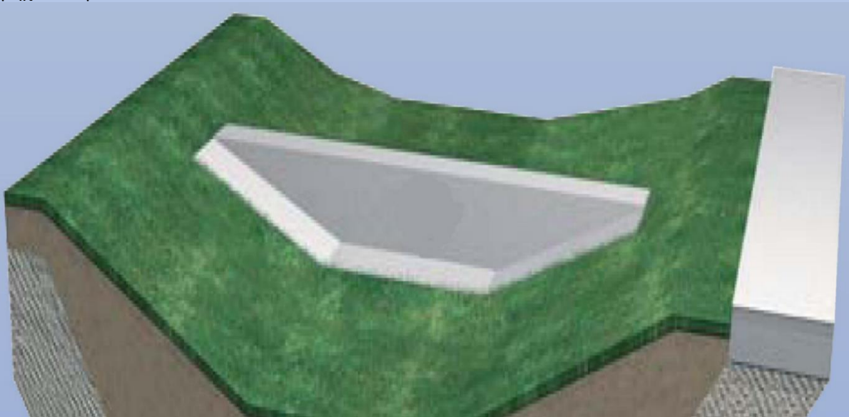
Εικ. 17 Χαμηλή υπερύψωση για τη μείωση της ταχύτητας ροής του νερού σε επιφάνεια διήθησης μεγάλης κλίσης.
